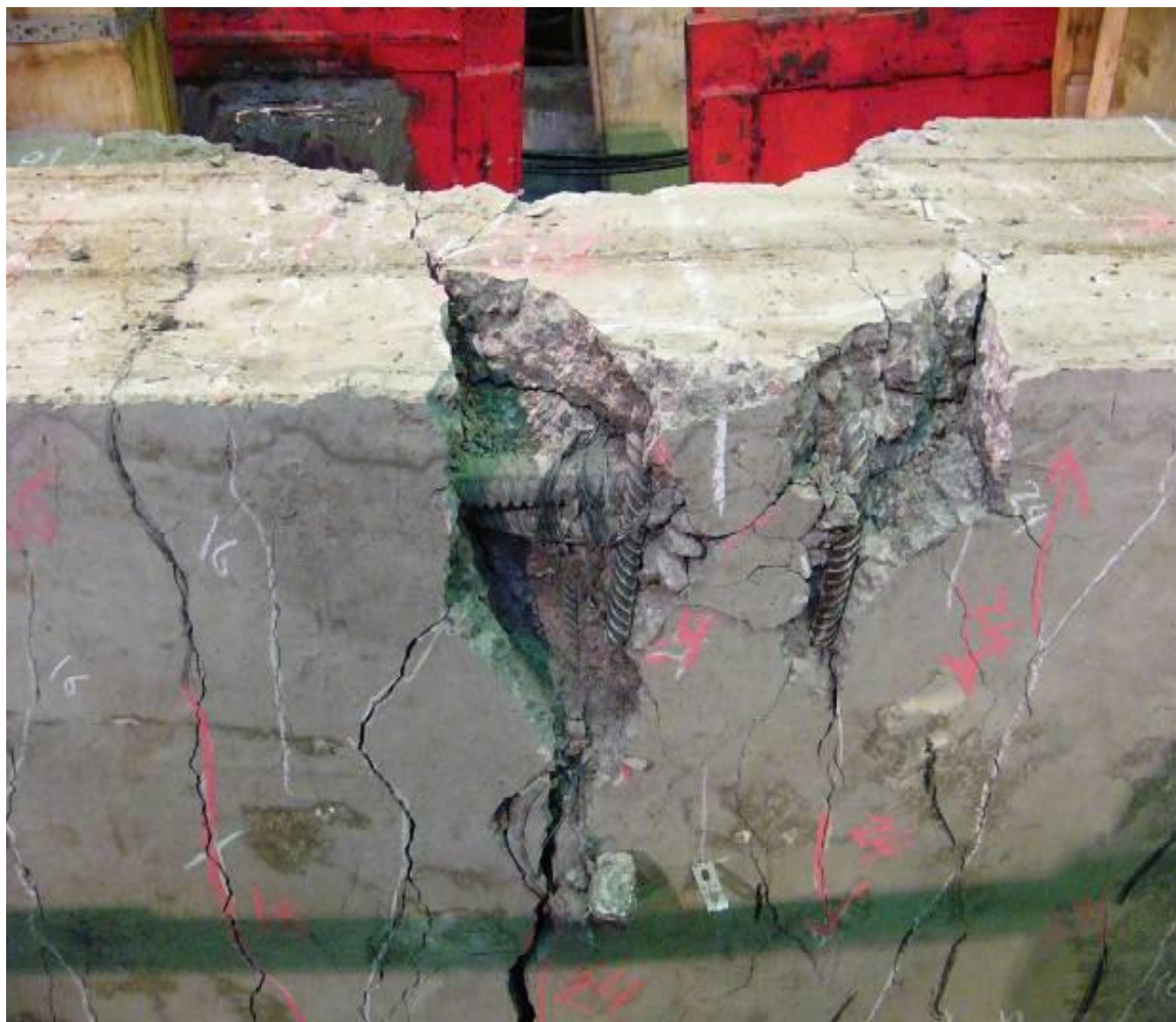
Рис. 6. Разрушение модели при действии предельной нагрузки
