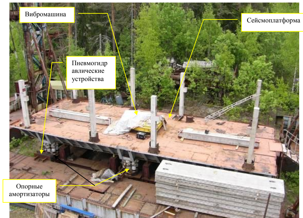
Рис. 1. Сейсмостенд ВСС-300. Общий вид
