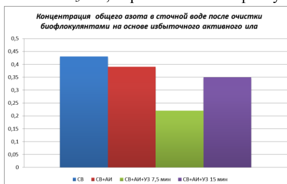
Рис.3. Концентрация общего азота в СВ после очистки биофлокулянтами на основе ИАИ.
