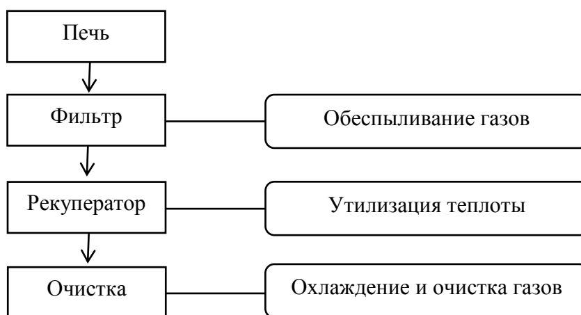
Рис. 3. Схема технологии рекуперации теплоты и очистки высокотемпературных газов
