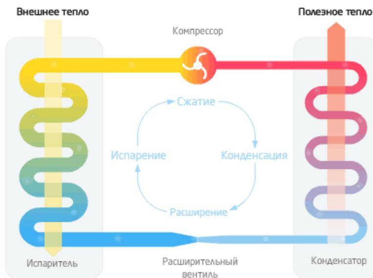
**Рис. 1. Принцип действия теплового насоса**
