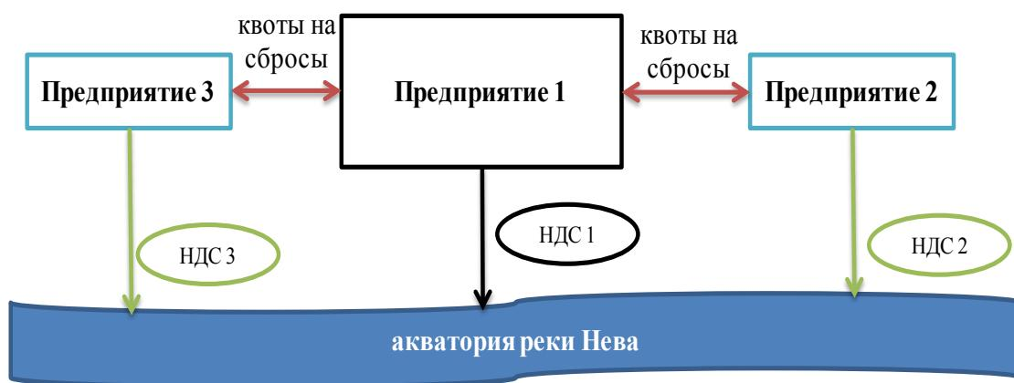
Рис. 1. Схема сброса сточных вод в акваторию р. Нева
